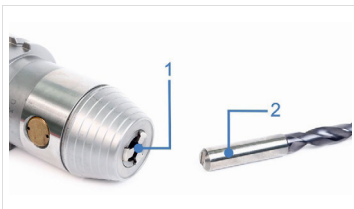
Abb. 4: Präzisionsbohrfutter und Werkzeug reinigen
